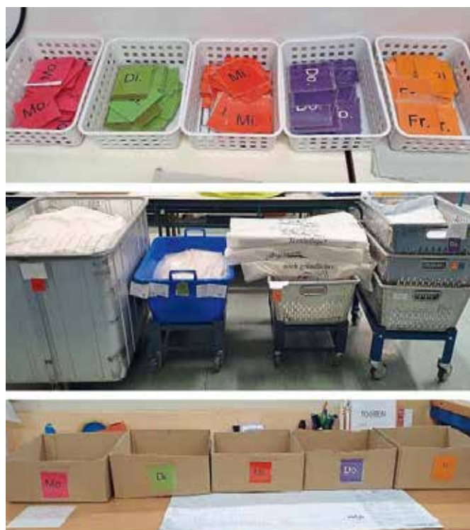
Eingehende Wäsche markieren die Mitarbeitenden mit Farbkarten: Sie stecken sie an die Wäschewannen und legen die Auftragszettel in die farblich passende Box. Wie die T-Shirts der Mitarbeitenden wechseln die Farben täglich. Welcher Tag bzw. welche Farbe dran ist, zeigt ein Kalender in der Umkleidekabine.
